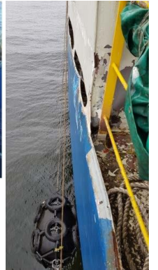
二次フェンダーの設置位置、低過ぎまたは後ろ過ぎであり、船体の損傷を防ぐことができない。
