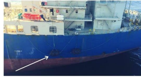
二次フェンダーの設置位置、低過ぎまたは後ろ過ぎであり、船体の損傷を防ぐことができない。
