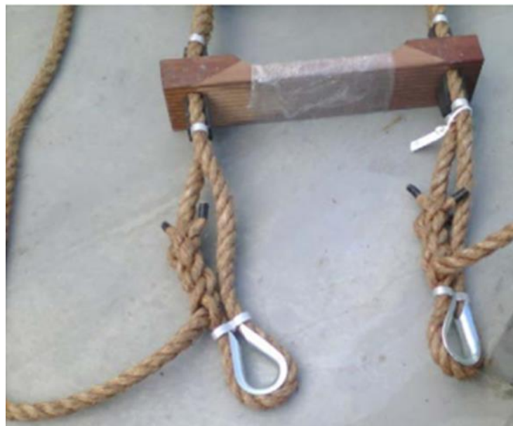
图片 12: 不符合要求的边绳有编接的引水梯示例。
