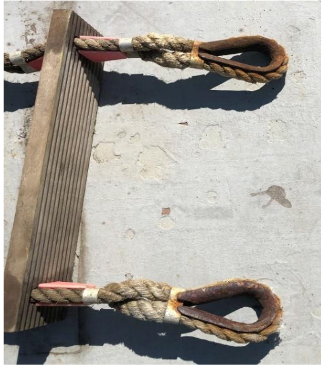
图片 9: 眼环衬套锈蚀示例 (图片使用权获得了弗里曼托尔港务局许可)。
