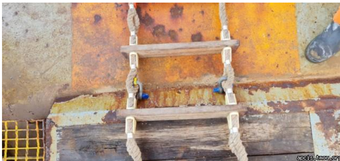
图片 5：不安全的引水梯固定装置。
