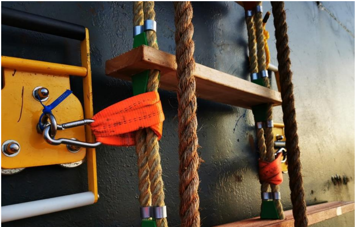
图片 1：使用磁吸垫固定引水梯和舷梯的示例（图片使用权获得了弗里曼托尔港务局许可）。
