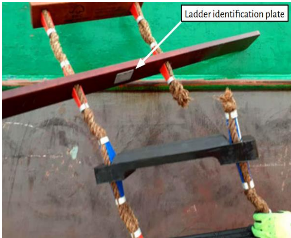
图片 8: 使用时边绳断裂的引水梯（图片使用权获得了 MAIB 许可）。
