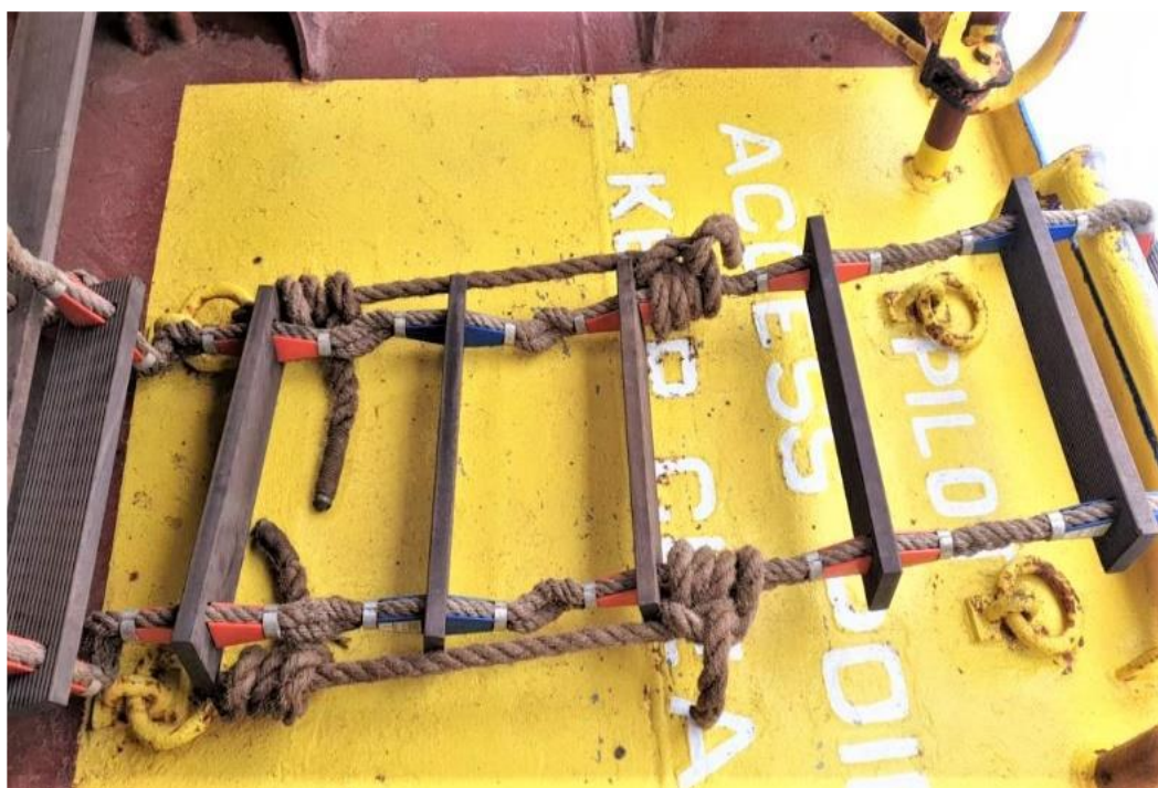
图片 7: 使用三套结将引水梯固定到主甲板许可的固定点（图片使用权获得了弗里曼托尔港务局许可）。
