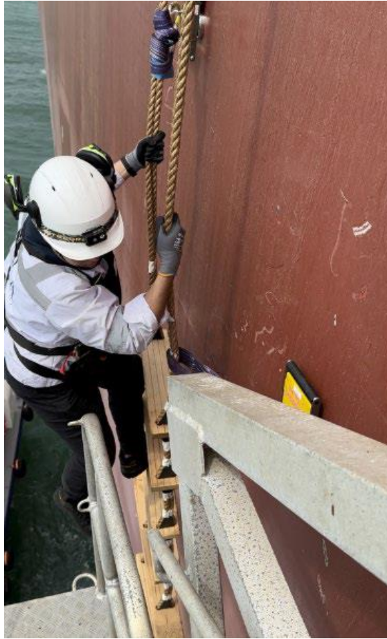
Larawan 3: Isang tao na nahihirapan sa ligtas na paglipat mula sa hagdanan ng pilot (pilot ladder) patungo sa plataporma ng “accommodation ladder”
