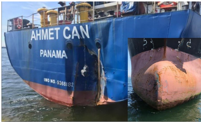
TM 12/2020 – AhmetCanの船尾への損傷とPersenkの船首への軽微な損傷
